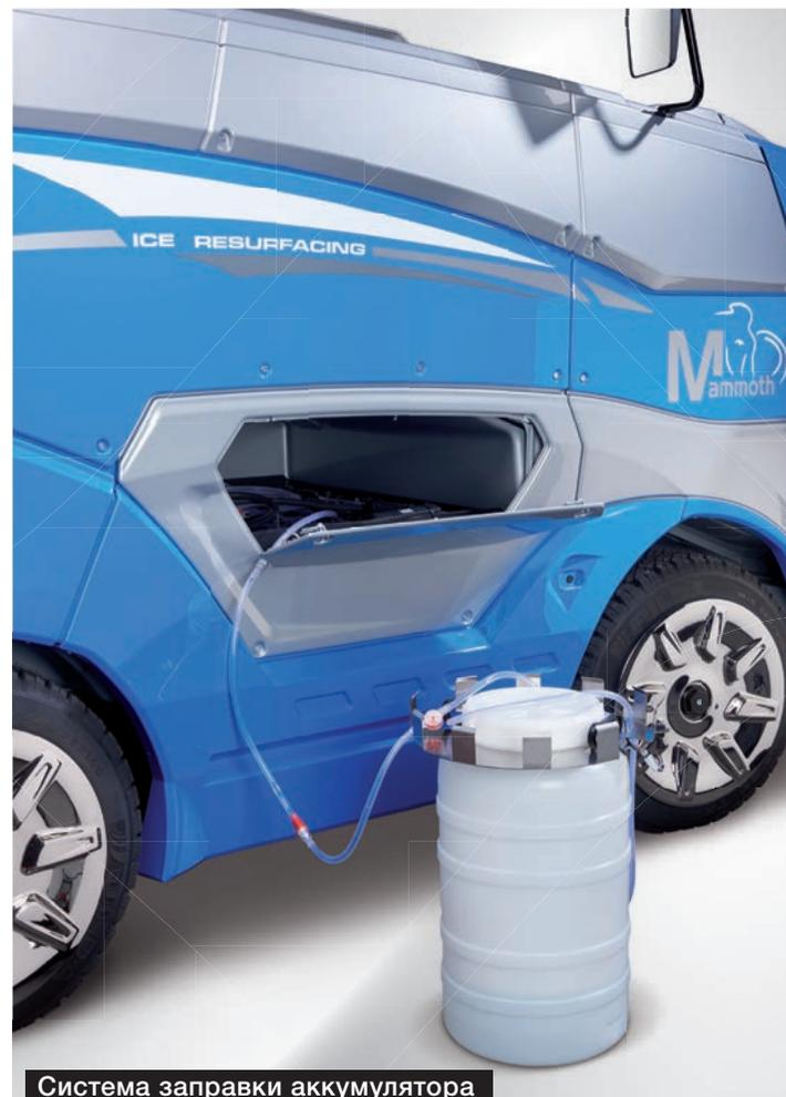
Прочная, закрытая свинцово-кислотная аккумуляторная батарея повышенной надежности и долговечная система зарядки от Fronius — это комбинация высочайшего качества. Система зарядки является высокоинтеллектуальной, автоматически распознает возраст и состояние заряда аккумулятора, заряжает очень быстро и экономит энергию. Вода быстро закачивается в аккумулятор через централизованную систему наполнения.
