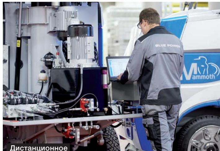
Можно просто откинуть кабину, так как вся техника в моторном отсеке находится в свободном доступе. Таким образом, специалист может быстро и аккуратно выполнить работу, что экономит время и затраты на обслуживание. Наша команда также контролирует состояние машины с помощью дистанционного обслуживания и устраняет любые неисправности.
